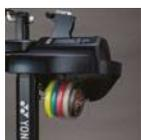
**STAURAUM MIT ROLLENHALTER & AERO COVER:** Eine platzsparend unter dem Arbeitstisch platzierte Halterung bietet viel Stauraum für die Saiten. Das "Aero Cover" wird separat zur Besaitungsmaschine verkauft. Es ist leicht zu montieren und bietet eine gute Möglichkeit, mehr Stauraum zu schaffen.
